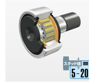
内部空間に「Cループ」を封入したメンテナンスフリーを実現したカムフォロアです。「Cループ」は、多量の潤滑油と微粒子の超高分子ポリオレフィン樹脂を熱処理固化した潤滑剤で、外輪が回転することにより、「Cループ」から潤滑剤が軌道面に常時適量しみだし、長期間にわたってカムフォロア内部の潤滑性能を維持します。
