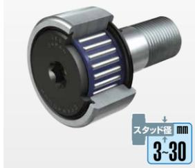
カムフォロアは、厚肉の外輪に針状ころを組み込んだスタッド付きの軸受で、外輪回転用に設計された摩擦係数が小さく回転性能に優れた軸受です。標準カムフォロアCF…Bはカムフォロアの基本的な形式でサイズバリエーションが豊富で、スタッド径最小3mmから最大30mmまで取り揃えています。
