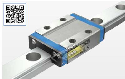
軌道と4点で接触する鋼球を2条列に配置した構造のため、極めて小形にもかかわらず、方向や大きさが変動する荷重や複合荷重が作用する用途でも安定した精度と剛性が得られます。ステンレス鋼製を基本仕様として形状やサイズの種類が豊富にそろっており、用途に応じて適切な形式を選択できます。
