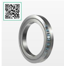
クロスローラベアリングは、内輪と外輪の間に、ローラを直交させて配列したコンパクトな構造の軸受です。転がり面は線接触のため、荷重による弾性変位はごくわずかであり、しかもラジアル荷重、アキシャル荷重、モーメントなどの複雑な荷重を同時に受けることができます。コンパクトで高い剛性と回転精度を必要とする医療機器などの旋回部に広く採用されています。
