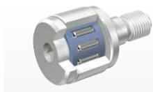
外輪に極めて細かい針状ころを組み込んだ軸受で、スタッド径に対して外輪外径の小さいコンパクト設計になっています。電子部品装置・OA機器及び小形インデックス装置などに使用されています。
