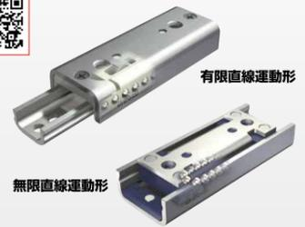
ステンレス鋼板をU字形に精密成形し、軌道部分と取付面を一体化することで軽量化を図り、各部品を機能的に配置して小形化を実現しています。
