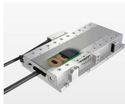
NT...Hは、テーブル案内部にローラタイプのラック&ピニオン内蔵形クロスローラウェイを使用し、1μm以下の位置決め精度と走行真直度、高い剛性と空気静圧軸受にせまる脈動のないなめらかな動作を実現した高精度なリニアモータテーブルです。
