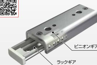
2条の鋼球列を一体形にした保持器にはピニオンギアが組み込まれており、テーブル及びベッドに固定されたラックギアと噛み合せて保持器の位置ずれを防ぎます。BSPと同様に円滑な有限の直線運動を行います。
