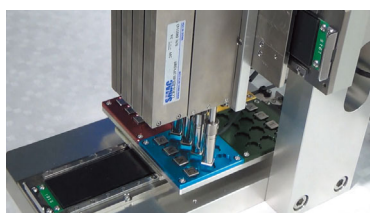
ナノニアNT と LCR16 を組合わせた ピック&プレイス用デモ機
