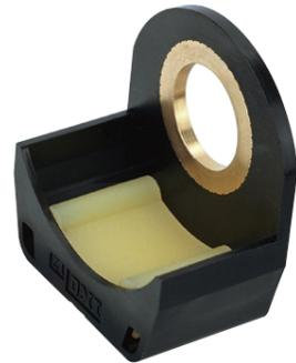
IKOカムフォロア用Cループユニットは、カムフォロアに取り付ける潤滑部品です。カムフォロア外輪外径面やカムガイド面に不可欠な潤滑油を供給するため、定期給油が不要です。
