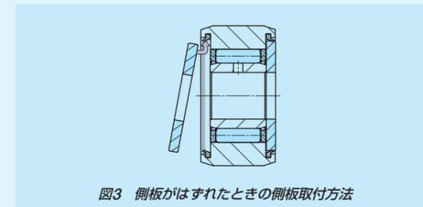
図3 側板がはずれたときの側板取付方法
