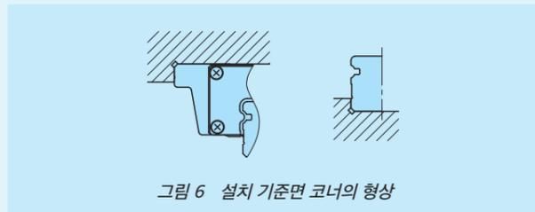
그림 6 설치 기준면 코너의 형상
