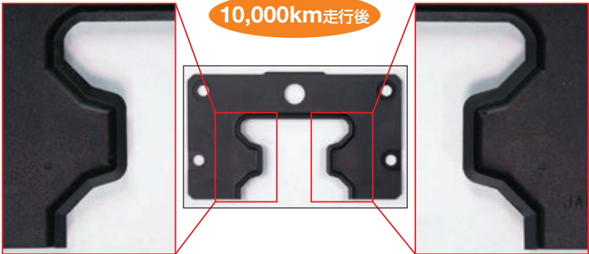
側面シールに損傷はありません。
