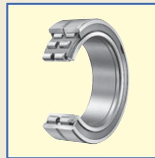
这是装入双列圆柱滚子的非分离型轴承，额定负荷大。不仅径向负荷，而且通过内外圈的挡边的端面也能承受轴向负荷，最适宜于作为固定侧轴承。
