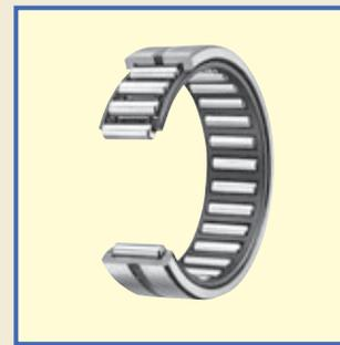
这是使用将材料切削、热处理后磨削精加工的外圈的轴承。外圈具有稳定的刚性，即便是轻合金等的轴承座也可方便地使用。
