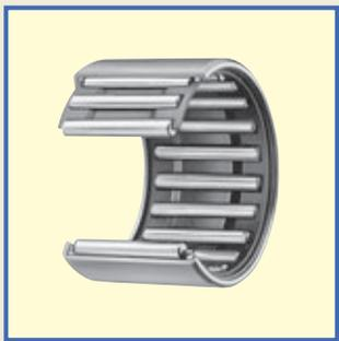
采用将特殊薄铜板经精密冲压加工并渗碳淬火后的冲压外圈，是在附带外圈的滚针轴承中截面高度最小的轻量轴承。
