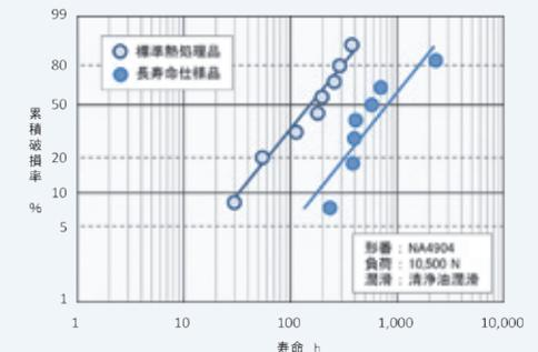
図1 寿命試験結果
