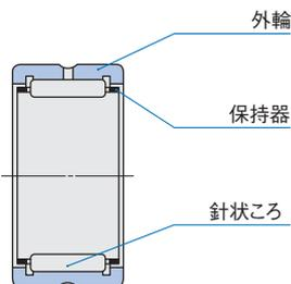
注(1) 軸受空間に熱硬化形固形潤滑剤Cループを封入しています。
